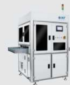
23 / 四头辊轮式等离子处理设备 XR-APO-RD1010-HN
